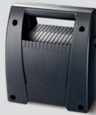
Akku-Pack Nennspannung 12 V DC, Nennkapazität 15 Ah, Nutzungsdauer 40 Tage bei max. 4 Öffnungen pro Tag und bei einer Temperatur von 20 °C, Temperaturbereich - 15 ° bis + 45 °C, integrierter Laderegler für Steckernetzteil • Geeignet für: Novomatic 423 Accu
